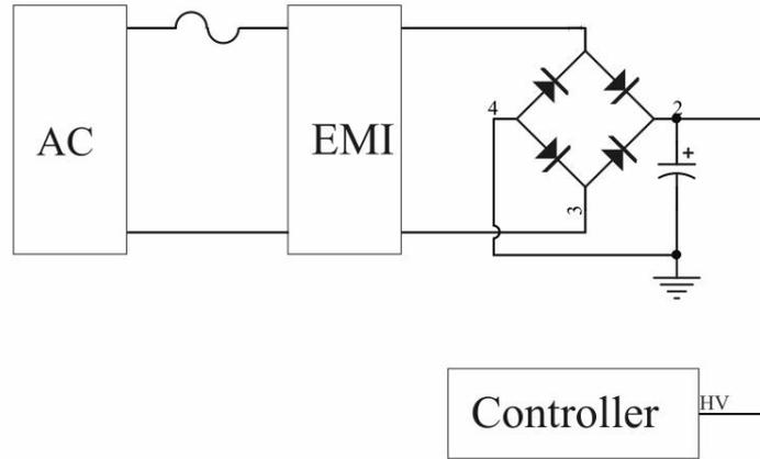
图 1：高压启动电路
