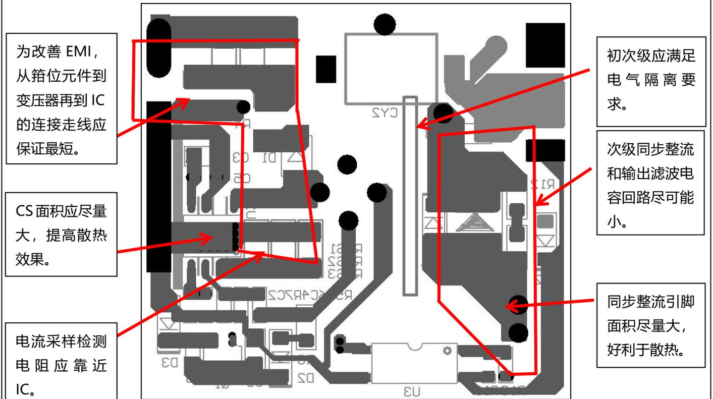
为改善 EMI，从箝位元件到变压器再到IC的连接走线应保证最短。
