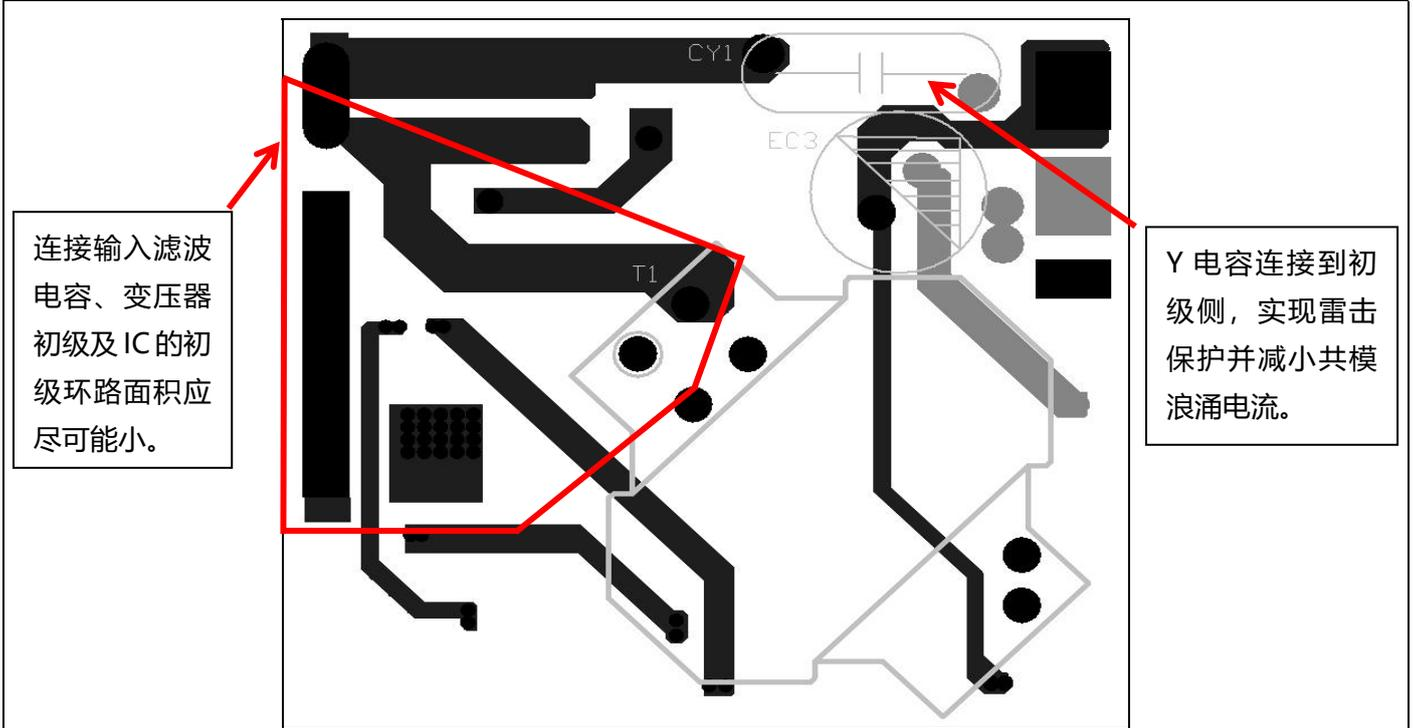
连接输入滤波电容、变压器初级及IC的初级环路面积应尽可能小。
