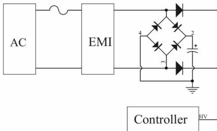
图 1：高压启动电路
