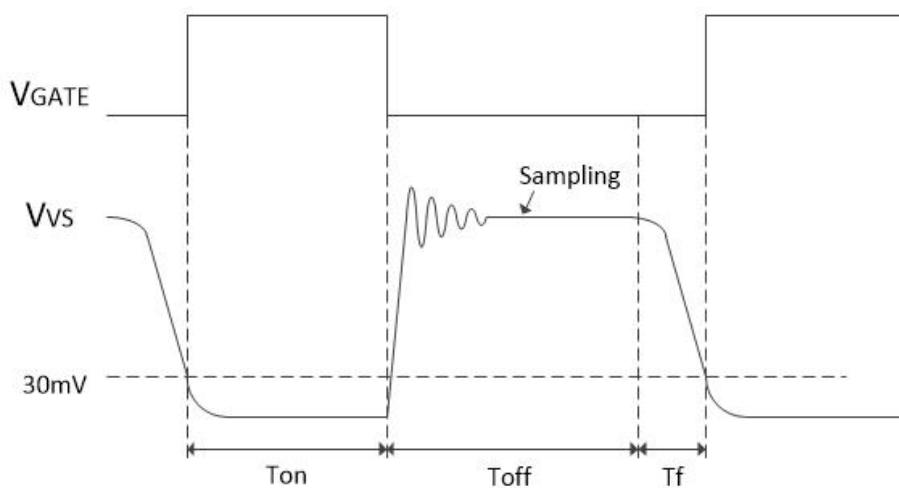
图 4: 辅助绕组波形及退磁检测
